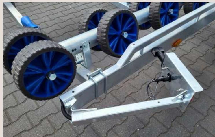
Klappbare wasserdichte LED-Beleuchtung
